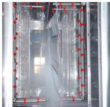
Dopo il trattamento i manufatti sono rivestiti da un film organico passivante continuo di spessore di circa 1 micron che incrementa l'adesione e la tenuta alla corrosione del ciclo di verniciatura **fino a 400 ore in nebbia salina** su ferro con vernice in polvere e costituisce un protettivo temporaneo che consente lo stoccaggio dei pezzi all'interno per alcune settimane.
